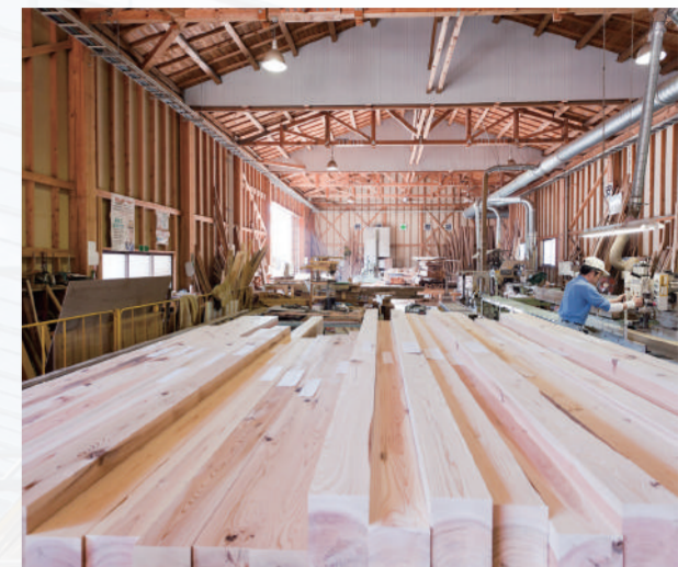
ToSMSにより乾燥された「登米杉」は、地域の職人の手で加工され木造災害公営住宅などに使用されます。
