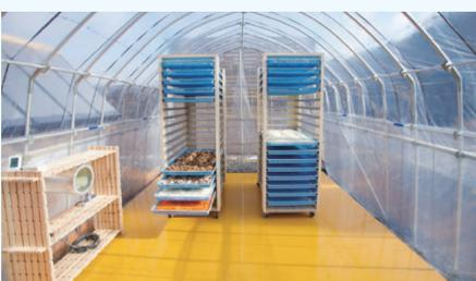
はなく、ローレベルエネルギーで可能なことはローエネルギーに切り替えていくことが求められ、パッシブソーラーシステム等の「太陽熱利用」が再評価されています。太陽熱食品乾燥実証実験施設 Ecochan は、天日乾燥を衛生的なビニールハウスの中で行い、太陽熱利用の空気集熱によって外部よりも平衡含水率の低い環境をつくり出すことにより、食材の乾燥を促進します。この技術を確立する為に現在、一年を通じた乾燥実験と、食品栄養素の評価試験を行っております。
