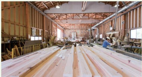
この構想はすでに災害公営住宅の建設を通して芽生えはじめています。震災復興を契機として高耐久性の木造住宅が求められる中で、宮城県登米市では森林組合が事務局となり、地域関連団体により木造災害公営住宅建設推進協議会を組織して、木材調達・製材から建築に至るまで「オール地元」にこだわった取組を行っています。オール地元方式では、森林組合が原木を供給し、地域製材所で住宅に必要な部材に製材して ToSMS で乾燥して地元の職人の手により建設されています。
