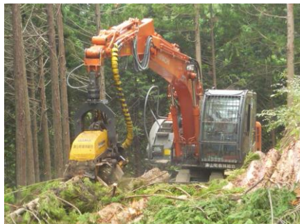
『ハーベスタ』(左)のアタッチメントは、業界屈指の作業能力を誇るボンセ社製 『フォワーダ』(右)は、IHI社製「F801」(リース車両) ※今後導入予定
